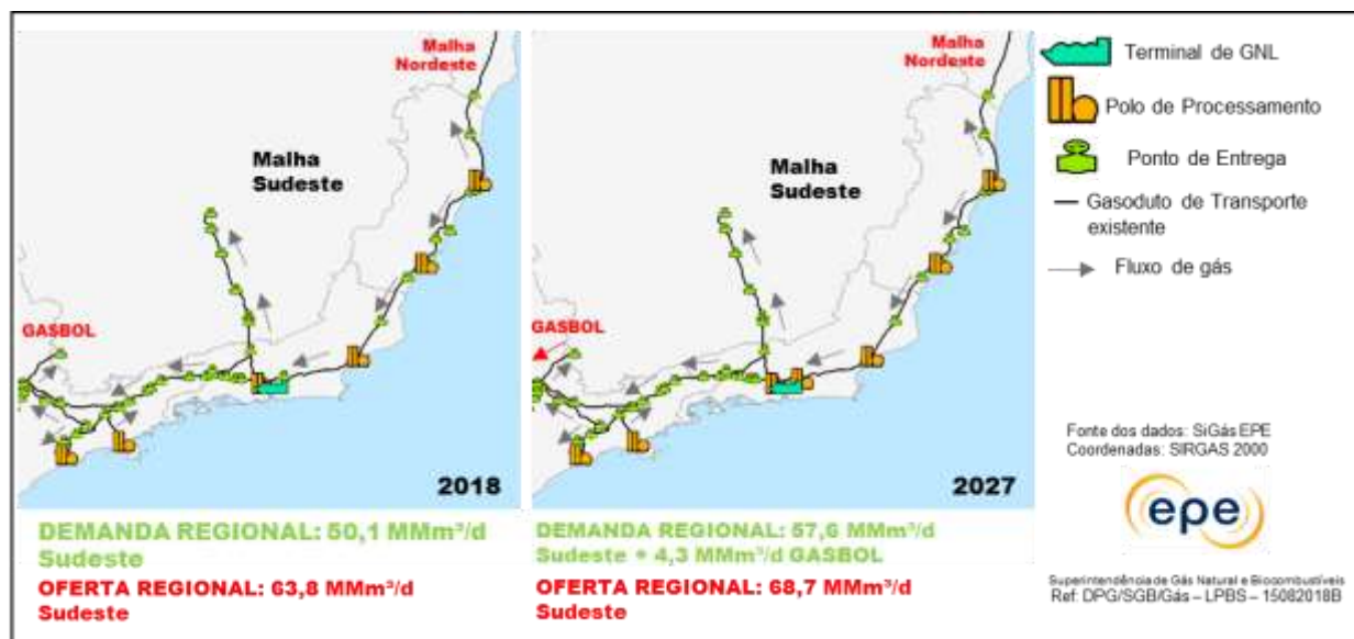
Figura 7-3 - Condições de contorno (oferta potencial e demanda máxima) para a simulação em 2018 e 2027 da malha Sudeste
